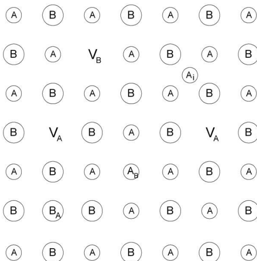
Рис. 2.1. Точкові дефекти кристалічної ґратки у сполуках АВ: вакансії V_A ( V_B ), міжвузлові атоми A_i та антиструктурні дефекти B_A ( A_B ).
