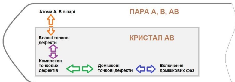
Рис. 10.5. Схематичне зображення можливих взаємодій точкових дефектів у системі «легований кристал – пара компоненту» в умовах двотемпературного відпалу.
