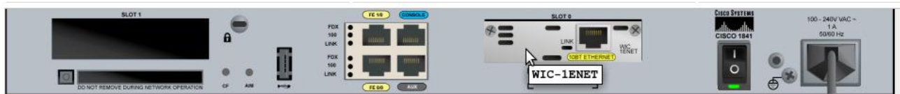
Рисунок 5.2 – Розміщення інтерфейсної плати WIC-1ENET у маршрутизаторі Cisco 1841
