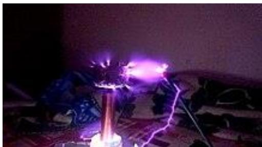
Рис. 2.27. Саморобний генератор озону. Озон утворюється в коронному розряді [68].
