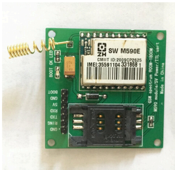
Рисунок 2.5 – плата модуля m590E із холдером SIM карти
