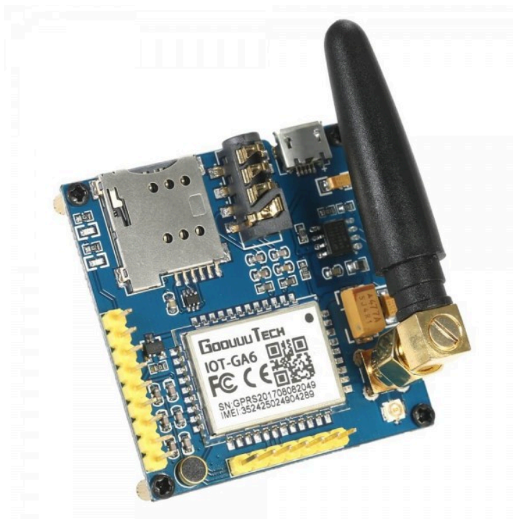
Рисунок 2.10– Вид плати із встановленим модулем GSM A6
