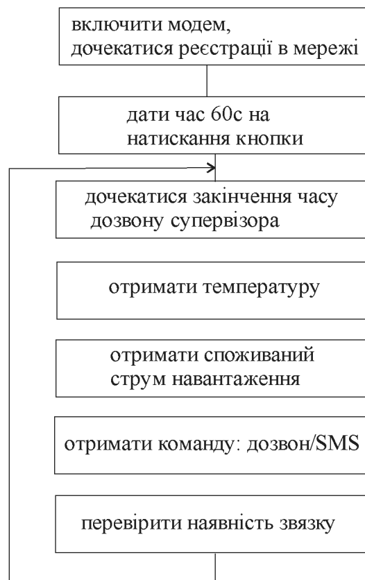
Рисунок 3.1– Діаграма роботи основного циклу програми
