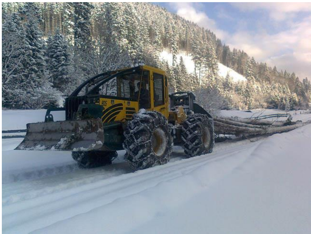
Рисунок 3.3 – Трелювання стовбурів сучасним колісним трактором HSM-805S
