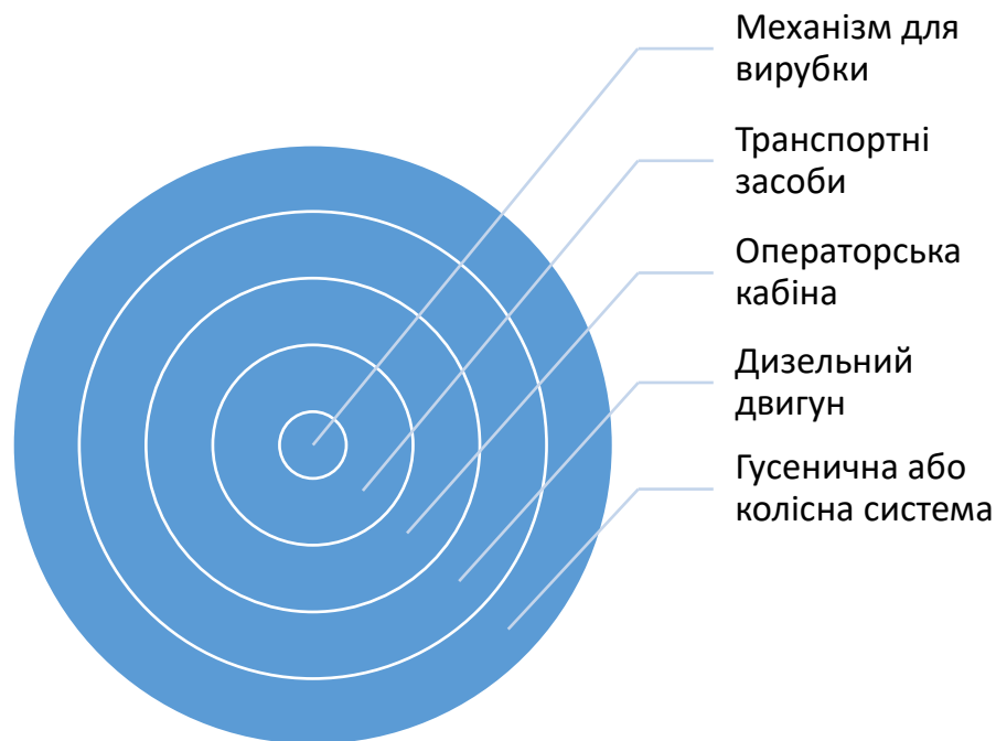
Рис. 1.3. Елементи трелювальних тракторів (побудовано автором)
